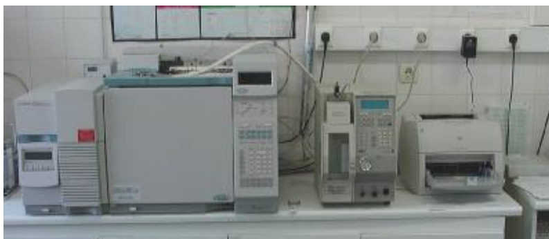
Εικόνα 1: Σύστημα ανάλυσης (Purge & Trap: O. I. Analytical 4560, GC – MS: Agilent 6890)
